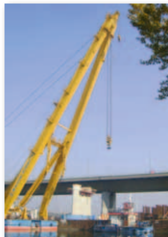
Felvonult a 200 tonna teherbírású, 50 méter magas Clark Ádám úszódaru is
